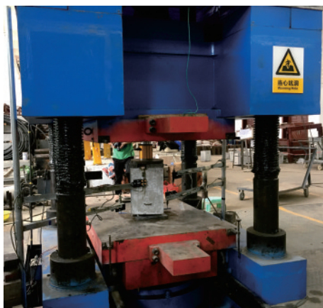
图 3 加载装置及位移计布置
